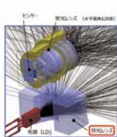
図2. 受光レンズとのマッチング評価による効果確認シミュレーション
